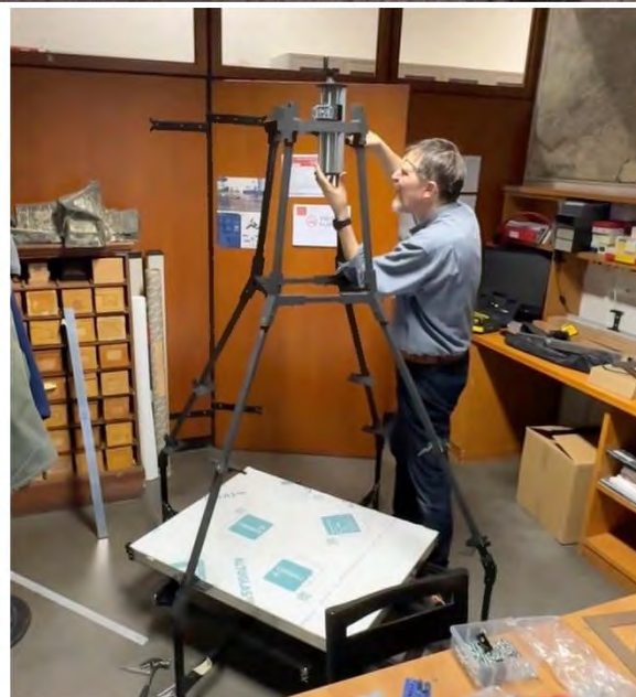
Figura 8. Stativo progettato e realizzato per le attività di ripresa del laboratorio.
