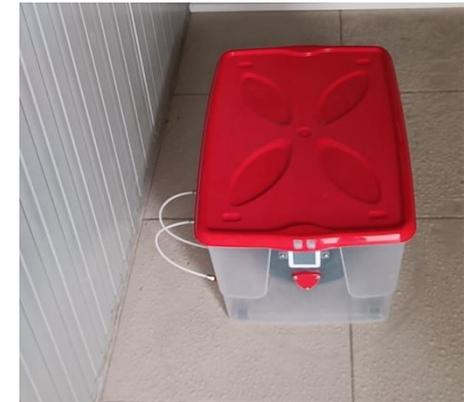
Test di tenuta della Dry Box nella camera climatica di COSMOB
